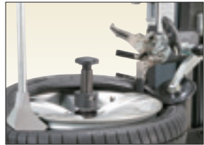
タイヤ組み付け作業 (サポートアームビードプレス併用)
