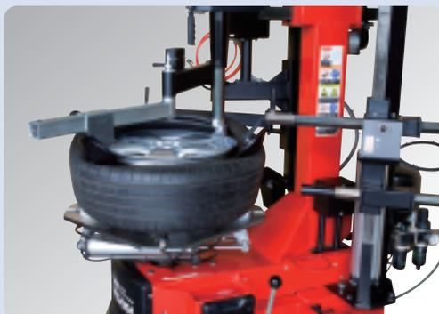
ビードプレス装置、マウントプレス装置の併用によりロープロファイルタイヤの組込を強力にサポートします
