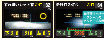
社内基準値設定後の合格表示 (○黄色) 光度値測定範囲外のランプ測定時に、「光度値オーバースケール」のメッセージを表示。
