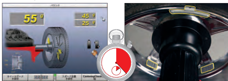
一般的な隠しウエイト機能は、必ず2本のスポークの裏側に貼付けウエイトを取付けます。これにより、作業時間が長くなります。
