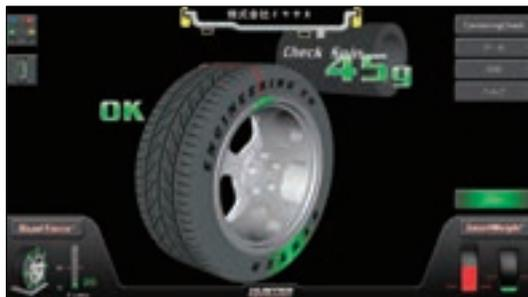
ServoDriveによるTDCレーザーは、打込みウエイト取付け位置を特定するときホイールの12時の位置に向けて照射されます。
