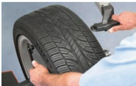
内側Dataset®アームおよび外側Dataset®アームにより、ホイールデータの入力時間を短縮でき、高精度なバランス調整が可能になります。
