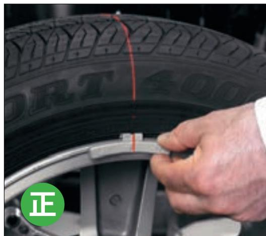
TDCレーザーをガイドとして使用すると、打込みウエイトをすばやく正確に配置することができます。
