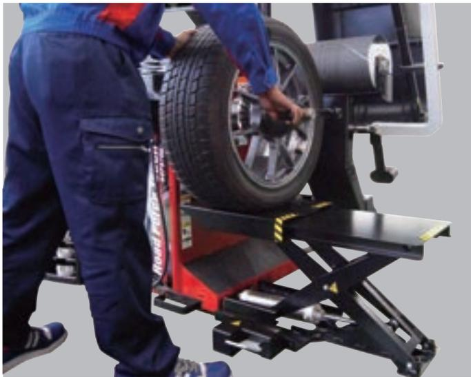
ホイールリフトシステムは、SUV-RV などの大径タイヤや、ランフラットタイヤなどを簡単・正確にバルンサーに設置することができます。
