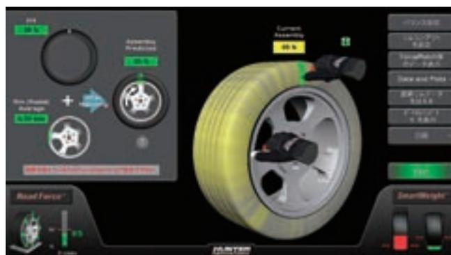
● 過剰なラジアルフォースはタイヤをリムに再度組み付け直すか、又は個々のコンポーネントを脱着し組み替え直す事により、除去することができます。(マッチング機能とマッチングコードの特長)
