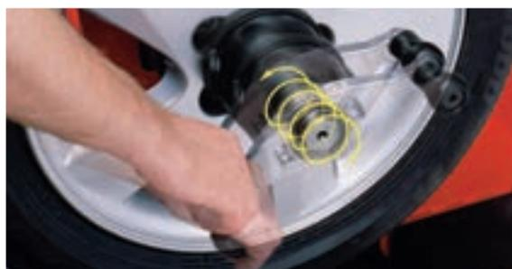
フットペダルを2回踏むと、残っているネジ山分だけスピンドルが自動的に回転し、ウイングナットを締めたり緩めたりできます。
