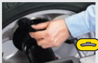
...ホイールリムにセットされた内側Dataset®アームにより、balanサーが自動的に打込みウエイトモードを選択します。
