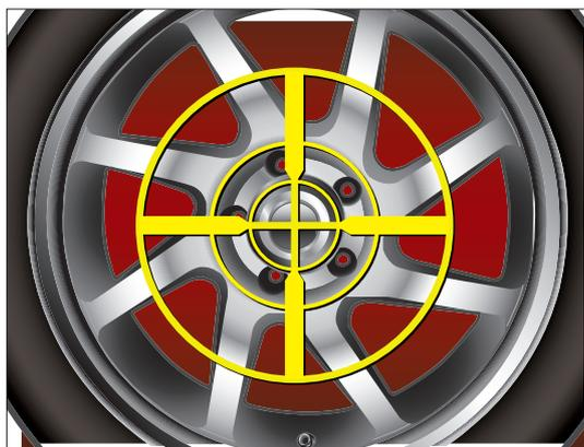
この機能はHunterホイール balanサー独自の機能で、balanサーにホイールを取付けたときにホイールをセンタリングします。取り付けアクセサリを選択する際の勘による作業や、問題のあるホイールで発生する不明なセットアップエラーを排除できます。
