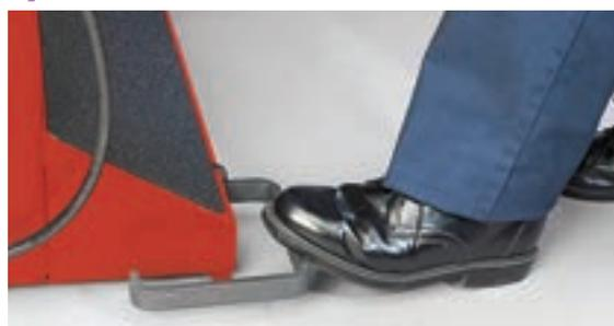
フットブレーキを踏んでホイールデータを入力できます。またフットブレーキでスピンドルを固定できるため、簡単にウイングナットを締め付けたり緩めることができます。
