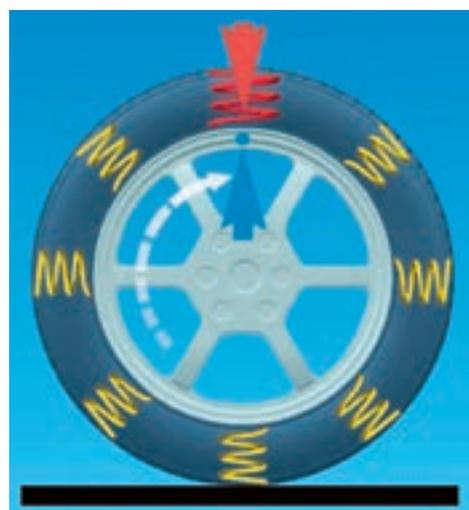
● タイヤ単体のラジアルフォースのハイスポットとリムのランアウトのロースポット位置のマッチングを行い、タイヤとホイールを最高の状態に組付け、走行安定性を向上させます。
