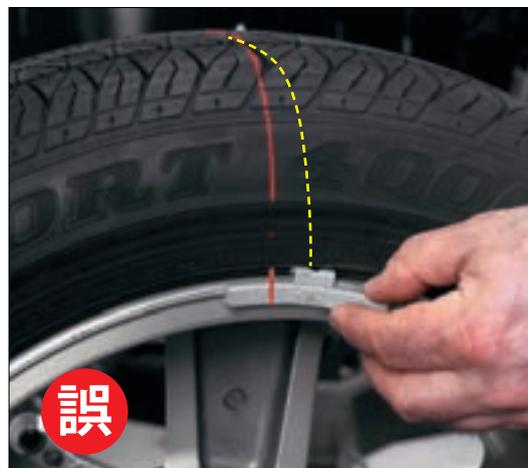
HammerHead™ TDCレーザーによって打込みウエイトの取付け誤差をなくします。取付け誤差が発生すると、ホイールバランスが悪化し、何度も測定をし直す事になる為大巾に時間を費やしてしまいます。
