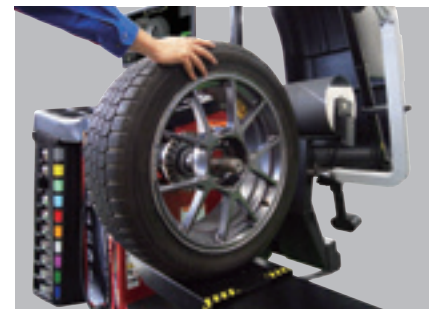
●シャフトにホイールハブをスライドさせて、セット完了。
