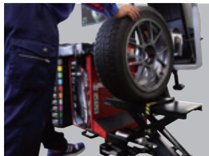
●ホイールの中心をシャフトの位置まで上昇させる。
