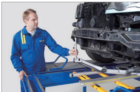
カロライナ社が開発するコンピューター計測システムは、どなたでも操作が簡単で使いやすく、もちろん高精度。車両のダメージ状況をコンピューターが即座に判断して、画面にわかりやすく表示します。
