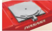
ターニングラジアスゲージも標準装備です。フロントシート部が脱着式になっていますので、電子式ゲージ※1への交換も容易です。
