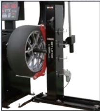
リフト台をスライドして バランサー主軸部に挿入
