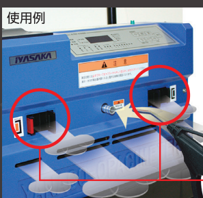
▲清掃治具装着例 左右掃気口の一番内側に装着します。
