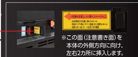
▲清掃用具装着例 左右掃気口の一番内側に装着します。
