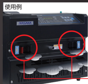
▲清掃用具装着例 左右掃気口の一番内側に装着します。
