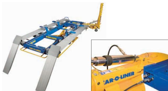
10t引きができるドロアライナーは、引き作業時の静音化を実現。これにより正確でパワフルな引き作業で使いやすさを向上しました。
