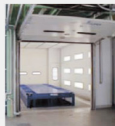
ビット内リフター& オーバースライドドア
