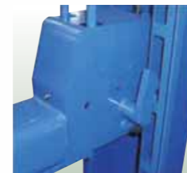
自然降下防止装置
