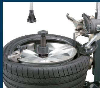
タイヤ組付け作業
