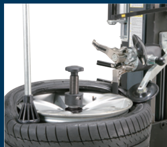
タイヤ組付け作業
