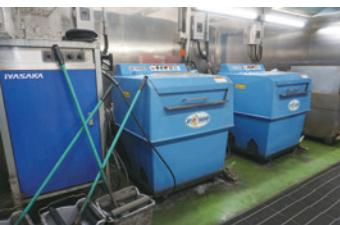
部品洗浄機は廃液交換等の設備管理を簡素化し、効率化を実現
