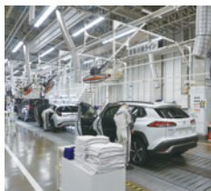
トヨタ新車点検項目に基づく点検を実施する新車点検ブロック。
