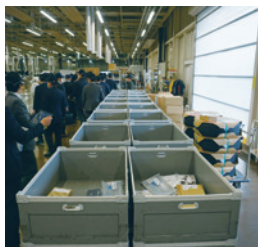
車両毎に部品が準備される部品庫。作業の進捗を示すモニター。
