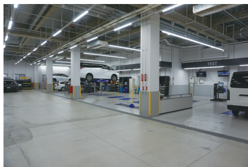
検査ラインを含めて全 7 ストールの整備作業場。空調完備、床面をノラメント仕様にし、メカニックの働きやすさを推進。
