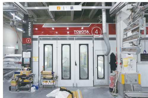
6 基の塗装ブースのうち 3 基が湿度コントロール機能付きを採用。リフト付きの塗装ブース。
