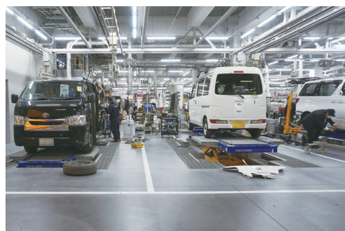
カラライナ・ベンチラック。フレーム修正機は計 10 基を設備。自社開発のシステムによる工程管理で生産性向上。
