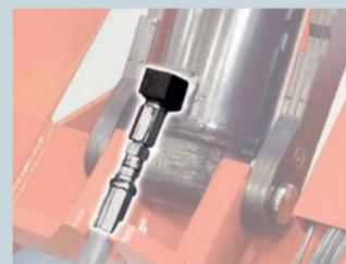
油圧ホールが破断した際、瞬時に油圧回路を遮断します
