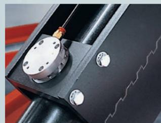
高精度の16段式歯型ロックで安全性を確立します
