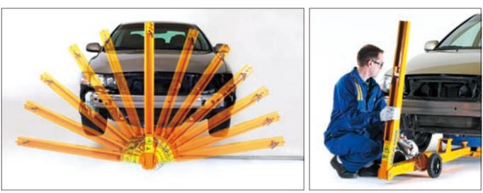
引張り能力5トンのドロアライナは、ベンチ前方に簡単にセットできます。ベンチがどの高さにあってもドロアライナは水平に180度振ることができます。また、新開発のバランスを内蔵しており、軽い力でポスト部の角度調整を行うことができます。スライディングハンマーなどでは修正できないような歪を5トンの油圧ラムにより簡単に修正します。
