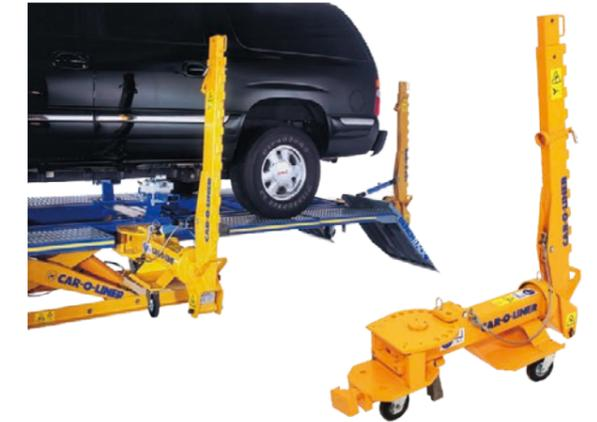
10t油圧ラムにより、最新材質の超高張力鋼板で造られた強固なフレームの歪も修正できます。ワークベンチの360度どの部分にも取り付けることができ、ピッチの違う2つの穴により引き角度を細かく自由自在に設定できます。ドーザータイプですので、一つのドアライナで多点引きが行えます。また、お手持ちのラムや下引き滑車を利用すれば、押し作業、上引き作業、下引き作業など応用性は無限大。標準セットには、2台装備されています。
