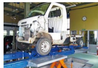
フレーム修正機への固定が難しい車両、複雑で変形が激しい車両でも、修正機とガッチリ固定することで、効果的な引き出し作業を行うことが可能で、修正作業時間を大幅に短縮します。
