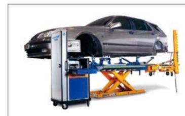
サイドシル固定のみでは二次損傷が発生してしまう高張力鋼板ボディでも安心して引き作業を行うことが可能になり、二次損傷のリスクが解消。大ダメージ車の修理も容易となります。
