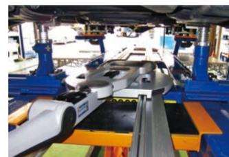
カートロニック高精度コンピューター計測システムとの組み合わせでスピードアップ、修正精度アップ。
