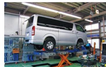
RV・4WD・1BOX車・軽トラック、最新の安全ボディ修正&固定に完全対応。固定ジグ機能で、より精度の高いボディアライニングを実現し、サービスメニューの拡充が可能。
