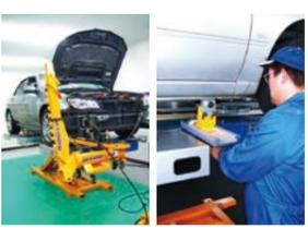
ドライブオン車両をリフトアップしてすぐ、クイック固定クランプ(2～4点固定)により、タイヤが接地したまま車両固定ができます。乗り込みから引き作業開始までのセッティングが、たったの5分と大幅な時短を可能にします。
