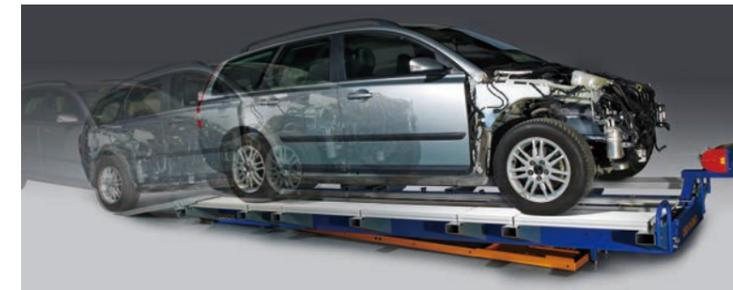
能力3,000kgのドライブオンリフト機能により、タイヤ乗入れ状態でリフトUPできます。また乗込み時のベンチ傾斜はリモコン操作で簡単です。
