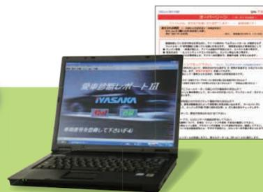
測定数値を基にエンジンの燃焼状態を分析するシステムで、パターン化した「診断ガイド」により誰でも簡単にエンジンの診断が可能です。
