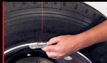
ウエイトの取付け位置を正確にレーザーで表示しミスを削減でき、上部の照明により作業部分を明るく照射し作業性をアップします
