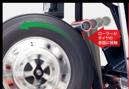
ローラーはタイヤのハイスポットを検出しマッチングを可能にし、正確な測定結果のため、全ての接触エリアを測定します
