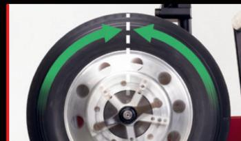
自動的に回転しウエイト貼付け位置の上死点、下死点で留まり時間の節約および正確性を向上します
