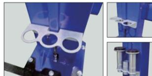
ショートアダプターとロングアダプターを収納する高精度加工により作られた専用ホルダーを左右のボールに装着しています。
