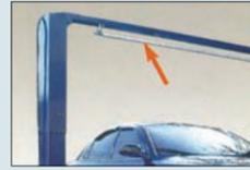
ワンボックス車、RV車等の車高の高いクルマの上昇時にルーフ部分がリフトのポストビームに当たらないように距離が既定値以下になると上限ルーフセンサーが感知し自動的にリフトの上昇をストップさせます。
