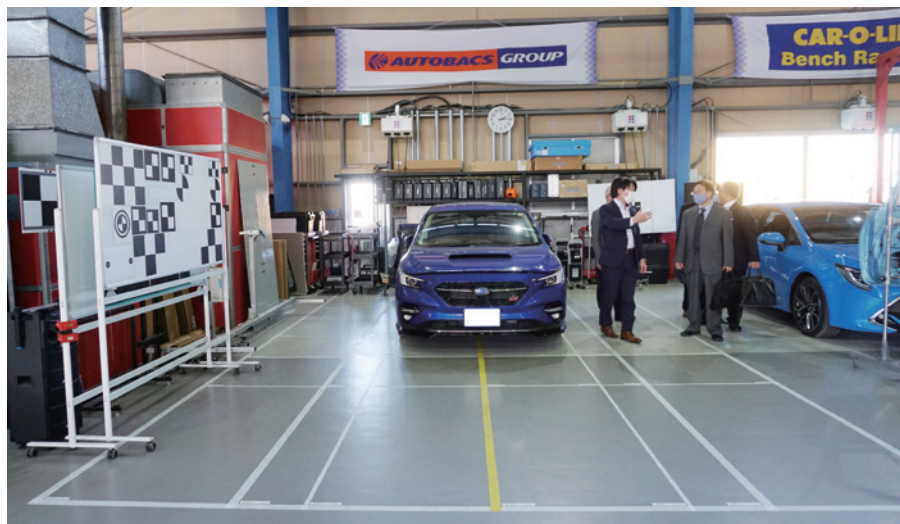
エーミング作業の専用スペース、「キャリブレーションエリア」。エーミング準備をスピーディに行うため、あらかじめ実線が引かれています。
