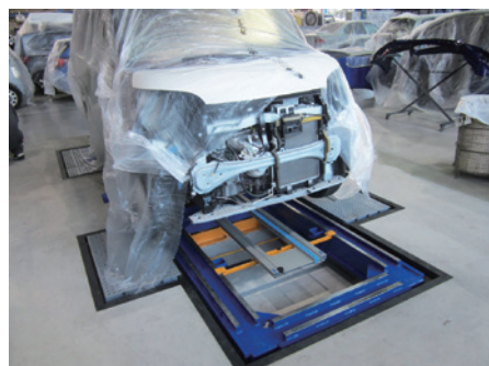
フレーム修正機はカロライナのベンチラック。あらゆるクルマメーカーに対応できる設備と技術を備えることに注力しています。
