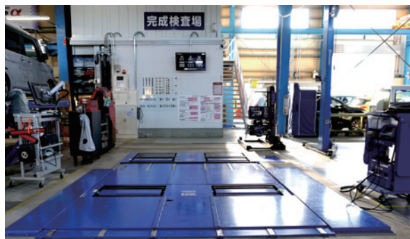
最新の IDIS α と前後同調式モーター付きの検査ライン、まさにハイエンドの検査ラインを導入。
