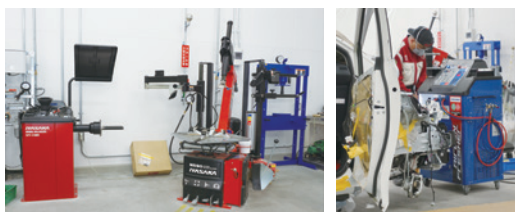
タイヤチェンジャーはNS-90、ホイールバルancerはVT-118を導入。Hfo-1234yfに対応するエアコンリフレッシュャー。
