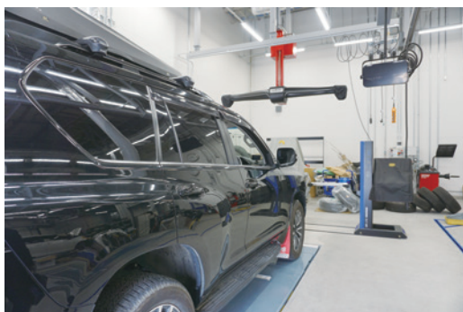
完成検査場兼エーミング作業場にはハンターの四輪アライメントテスターとヘッドライトテスターHLT-185を設備。
