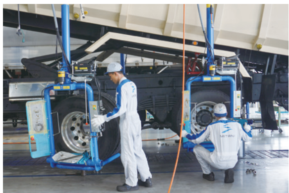
「スカイトレイン」はリフトであげた車両の高さを気にすることなく、一輪単位でホイールの脱着が可能です。
