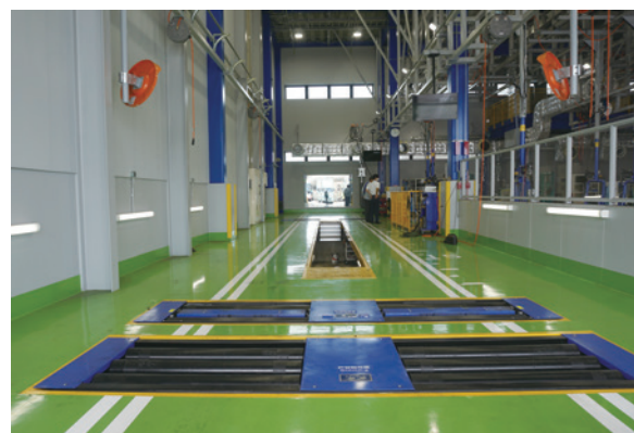
フルトレーラーの検査も可能な検査ライン。全自動検査ラインシステム IDISα の導入で車検業務を効率化。
