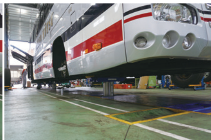
フラットツインリフトを使用したバスの整備。
