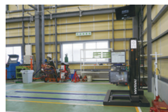
画像処理方式ヘッドライトテスター。モニターは 44 インチを設備。
