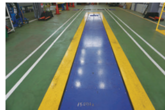
検査ラインにフロアリフトを導入。
